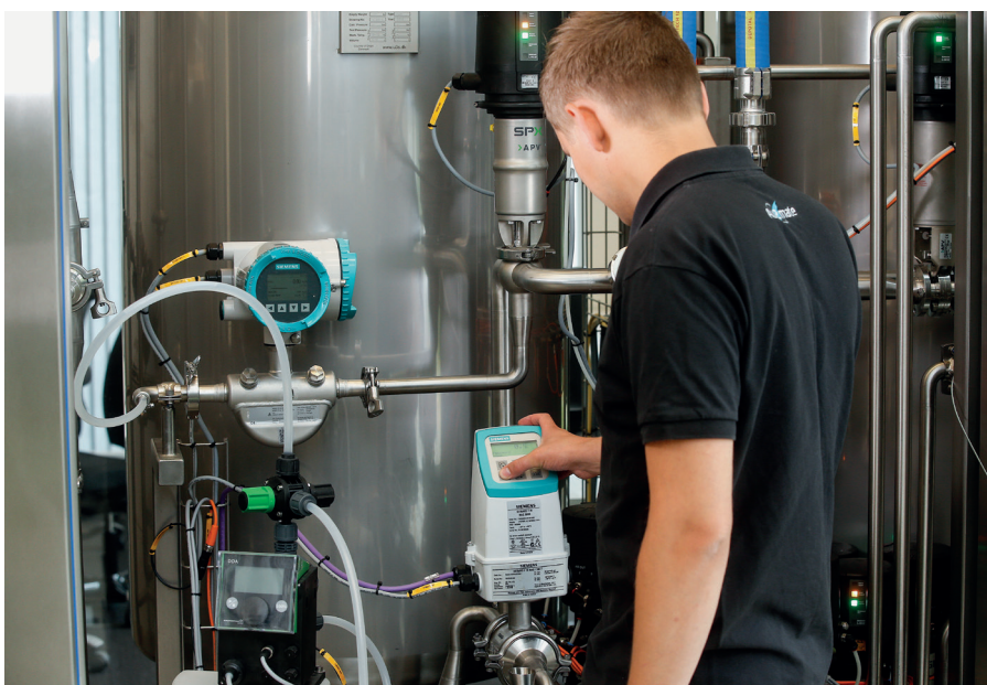
Au2mate Academy's testanlæg består af fem unit-tanke, der viser råmælksens forarbejdningsproces fra modtagertank til lagring af det færdige produkt.
