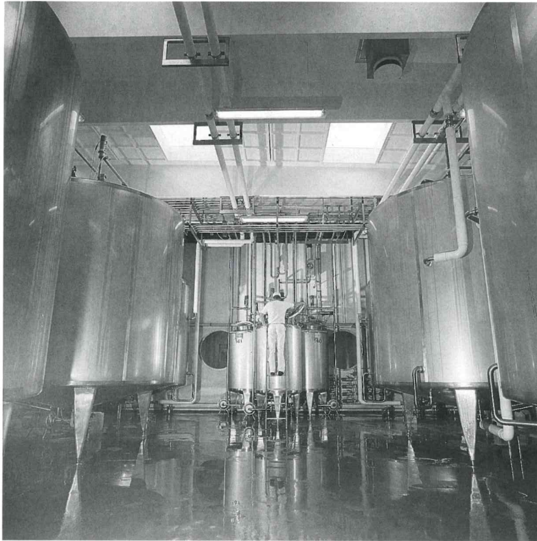
Den nye produktionshal omfatter tre fuldstændig separate linier til standardisering af løbe og koagulanter.
